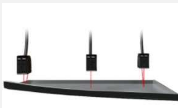
کنترل کیفیت - اندازه‌گیری جابه‌جایی
