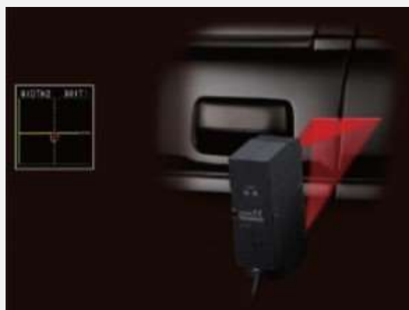
کنترل کیفیت - اندازه‌گیری شکاف درهای خودرو
