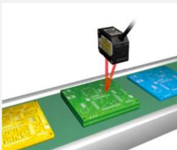
کنترل کیفیت - تشخیص مدارات چاپی (PCB) در یک بُرد
