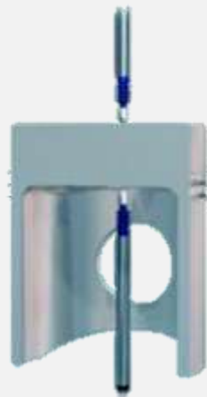
کنترل کیفیت - اندازه‌گیری قطر پیستون
